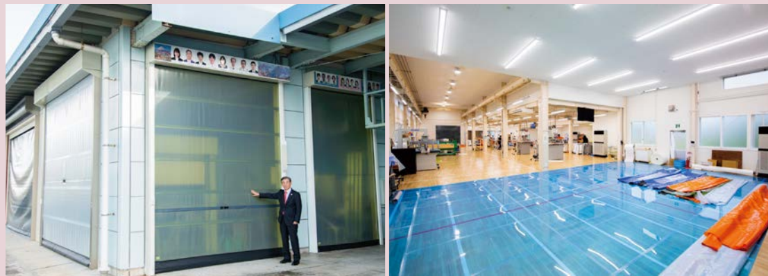
上／シートシャッターの製造ラインの横には歴代のシートシャッターが並び工場見学が行える。下右／創業地の八雲工場を創業 44 周年を期に新たな出発をテーマに改修。下左／強風や空気圧差にも強いパイプ入りの「happy gate 門番」。電気を使わず空気圧で稼働するタイプや、マイナス 25℃まで耐えうるタイプなど開発が続く。
